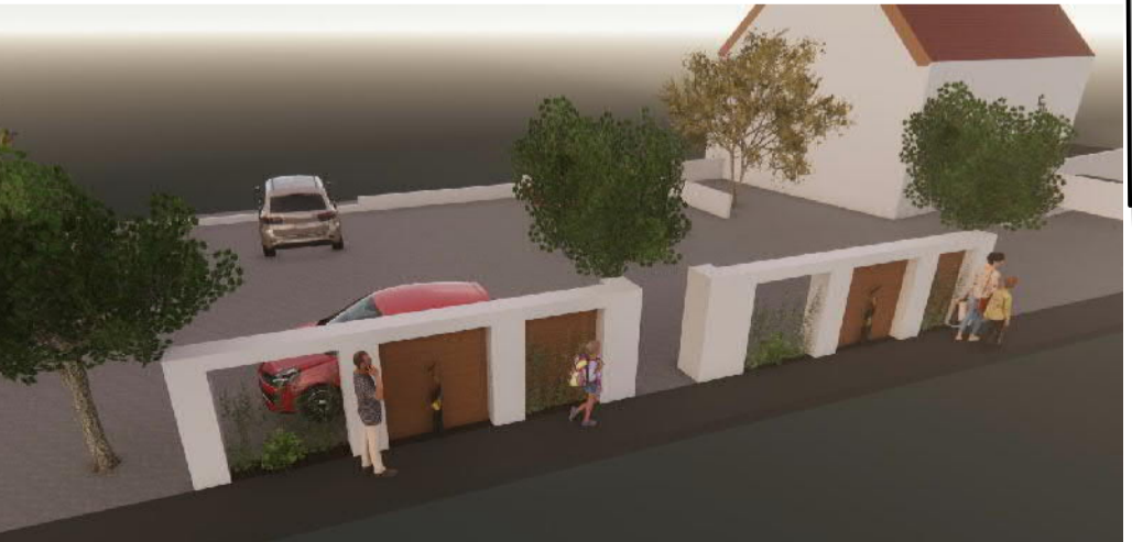
Mauer aus Betonfertigteilen (40 cm tief und 25 cm breit), Stahlseile mit Wandgitter und Platte über die Betonfertigteilen
